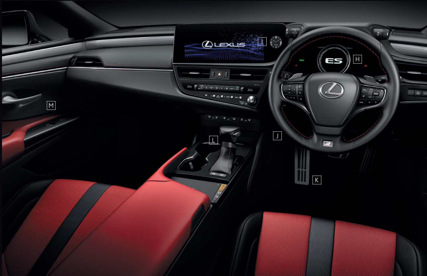
H_Meters & multi-information display / I_Clock / J_Steering wheel / K_Aluminum pedals / L_Shift lever knob / M_Trim H_มาตรวัดและหน้าจอ multi-information / I นาฬิกา / J พวงมาลัย / K แป้นเหยียบอลูมิเนียม / L คันเกียร์ / M รายละเอียดภายในห้องโดยสาร
