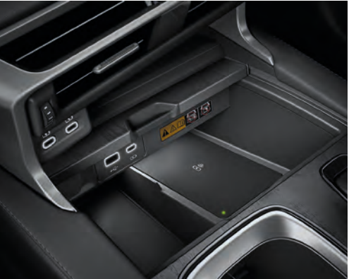
Wireless charger Set inside the front box with lid, it enables wireless charging of Qi-compatible smartphones and electronic devices simply by placing them on the charger tray. แท่นชาร์จแบบไร้สายสำหรับสมาร์ตโฟน ซ่อนอยู่ในกล่องเก็บของด้านหน้าคอนโซลกลาง เพียงวางโทรศัพท์หรืออุปกรณ์ที่รองรับการชาร์จแบบไร้สายลงบนแท่นชาร์จ
