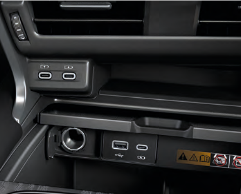
Center console: 3 USB Type C charging and USB Type A multimedia communication ports, DC12V คอนโซลกลาง: แท่นชาร์จ USB Type C ได้ 3 พอร์ต และ USB Type A สำหรับบลูทูธมีเดีย พอร์ตสื่อสาร DC12V
